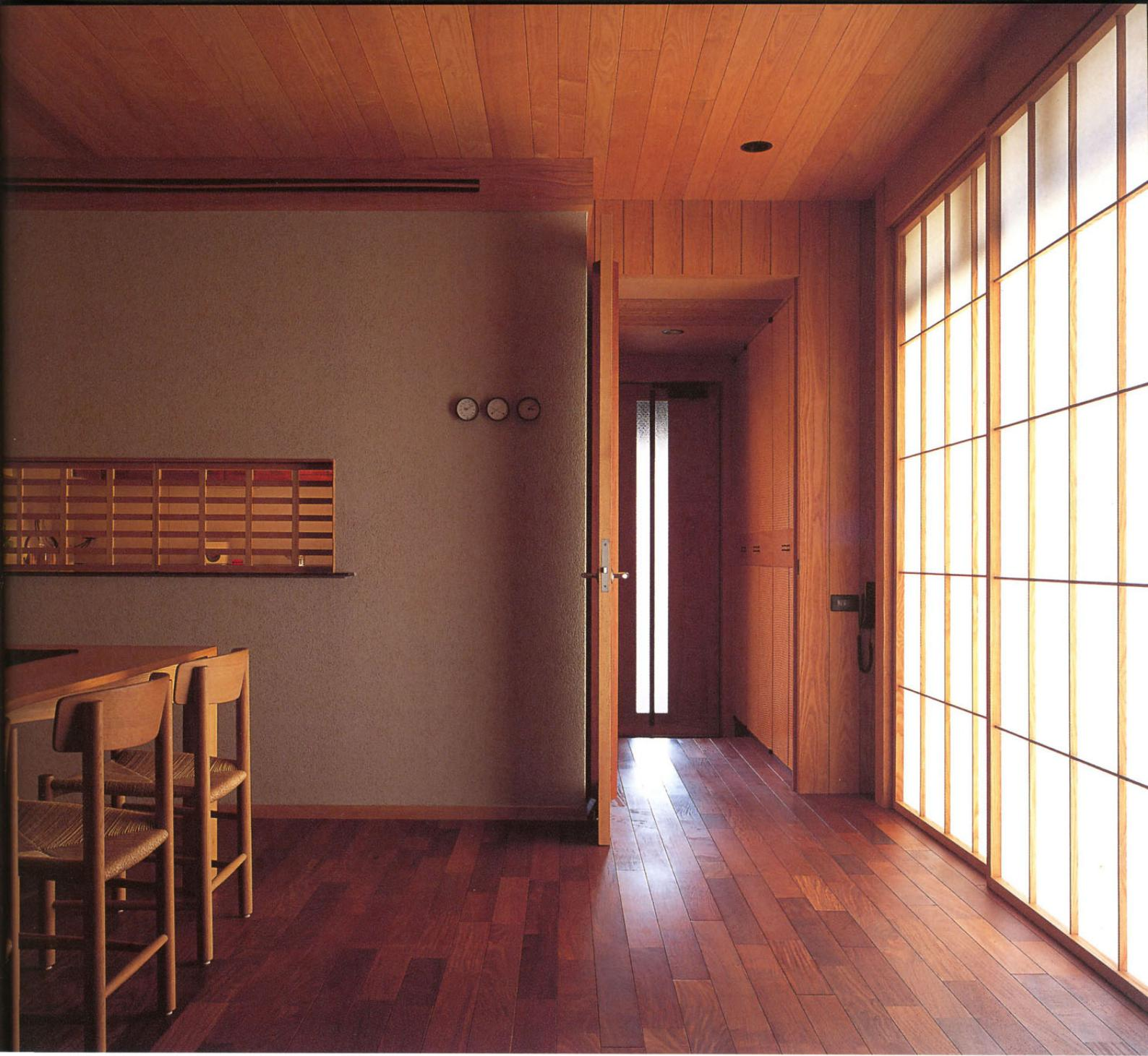
上/玄関方向を見る。左の小窓の向こうはキッチン。戸は引き分けられて、カウンターが配膳台となる。下/障子は敷居を設けず、フラットである。触れ止めに細かな処理を行なっている（p.42詳細図参照）。
